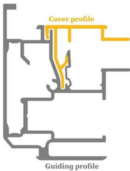
Bild 3: Unterdachmarkise Portofino, Querschnitt (Fabrique Invent, Lewens)
